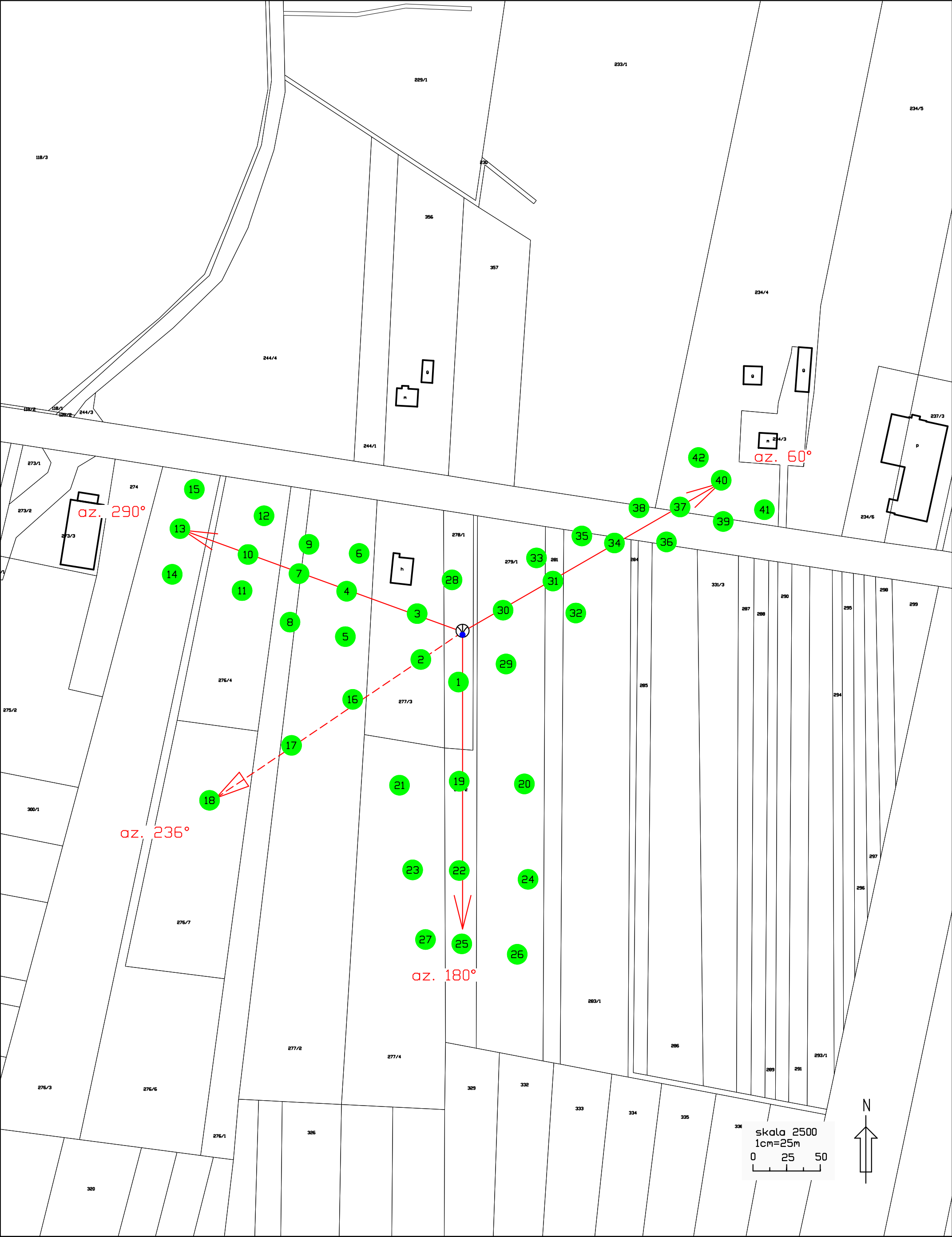
Rys.1 Lokalizacja pionów pomiarowych
